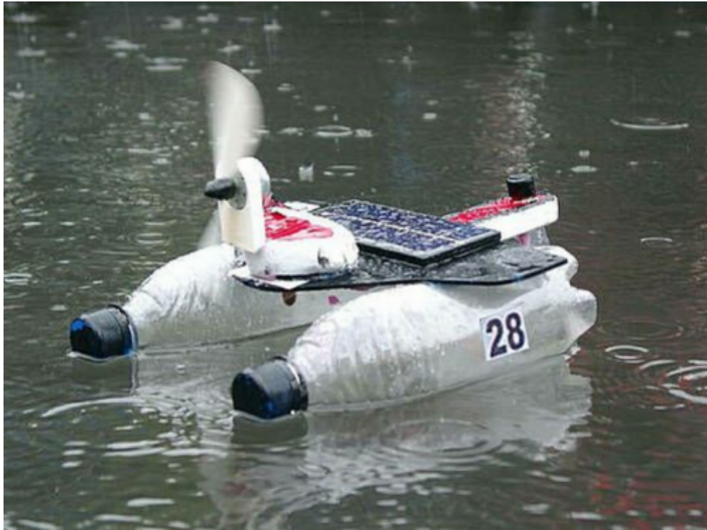
Beispiel Solarboot mit Luftschraube, Motor und einem Solarmodul Fotos des aktuellen Bausatzes findet ihr auf unserer homepage www.artefact.de .
