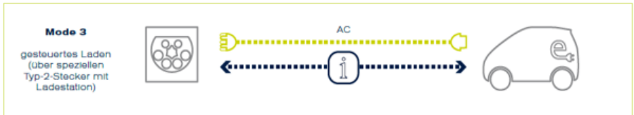
Abbildung 5: Ladetriebart 3 gemäß IEC, Quelle: (HafenCity Hamburg, 2013)
