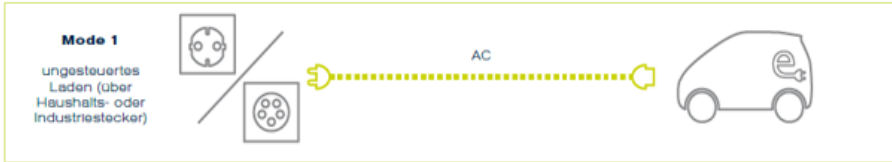
Abbildung 3: Ladebetriebsart 1 gemäß IEC, Quelle: (HafenCity Hamburg, 2013)
