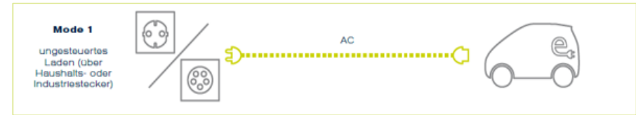
Abbildung 3: Ladebetriebsart 1 gemäß IEC, Quelle: (HafenCity Hamburg, 2013)
