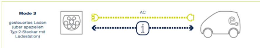
Abbildung 5: Ladebetriebsart 3 gemäß IEC, Quelle: (HafenCity Hamburg, 2013)
